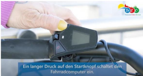
Ein langer Druck auf den Startknopf schaltet den Fahrradcomputer ein.
