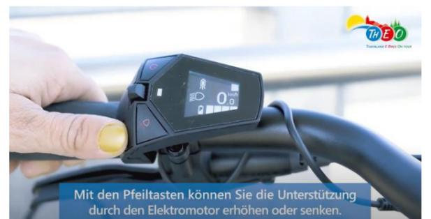
Mit den Pfeiltasten können Sie die Unterstützung durch den Elektromotor erhöhen oder senken.
